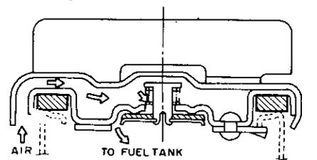
Fig. ET-50 Fuel filler cap
